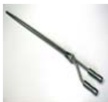
Serpentín de refrigeración
